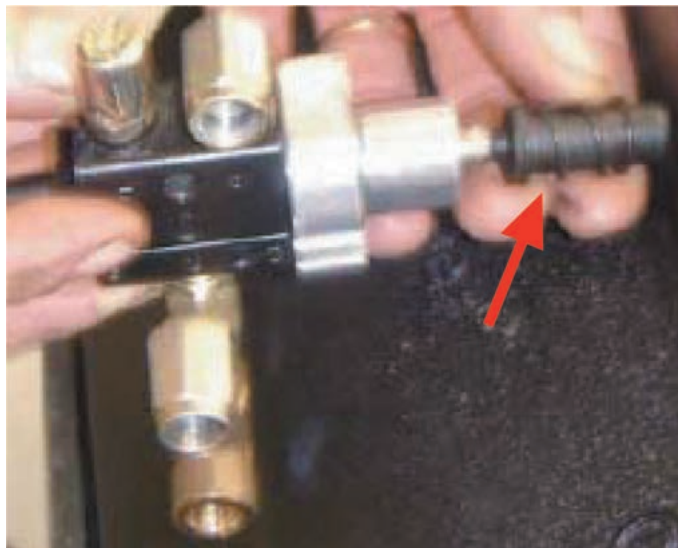
Montagem Correta do Pino e da Mola na Válvula de Escape
