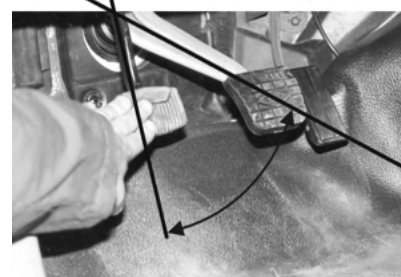
A folga no pedal deve estar entre 25 e 50 mm. Na foto a folga é comparada com o pedal do freio, ao lado
