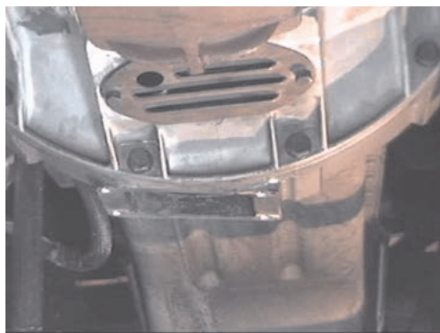
Remova a tampa de inspeção da capa seca.
