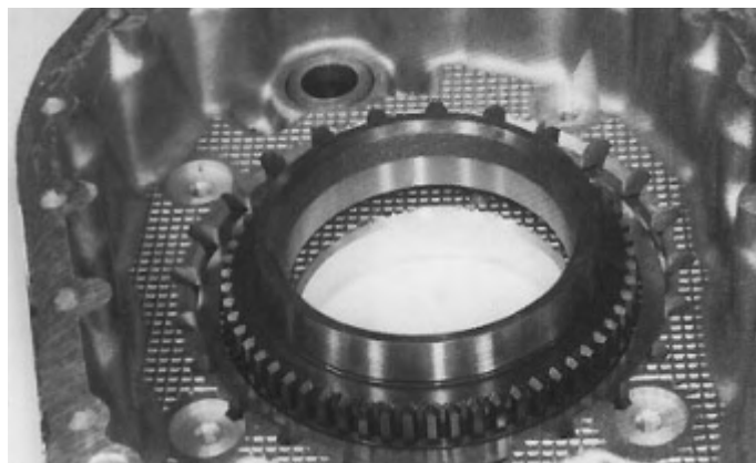
16. Coloque a flange de sincronização e o anel elástico no espaçador. Em alguns modelos um vedador de óleo adicional deve ser instalado na parte traseira da carcaça. Este vedador não deve bloquear o orifício de lubrificação do eixo de saída..
