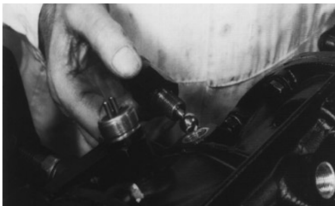
57. Instale o interruptor da luz de ré e aperte com torque correto.
