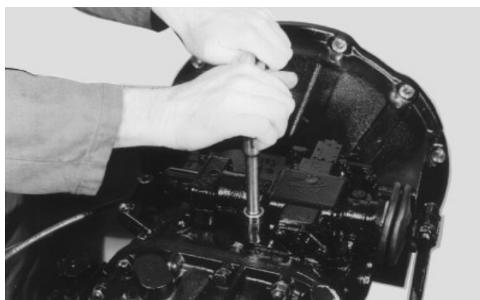
12. Aplique vedante na flange e instale o controle remoto. Certifique-se de que a alavanca interna esteja sobre o bloco seletor. Instale e aperte os parafusos com torque apropriado.
