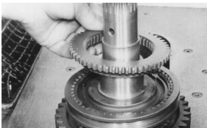
11. Instale a flange da engrenagem de ré no cubo sincronizador.
