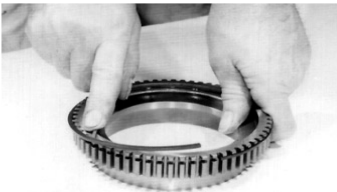
15. Caso seja necessário remova o anel elástico especial da flange de sincronização.
