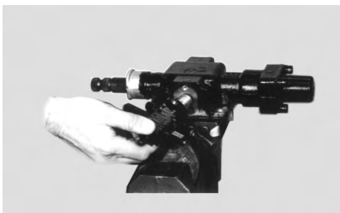
11. Aplique veda rosca e instale o respiro. Instale a válvula de acionamento utilizando uma nova junta de vedação. Posicione a válvula com as duas tomadas de saída voltadas para o lado esquerdo da carcaça e aperte os parafusos com torque apropriado.
