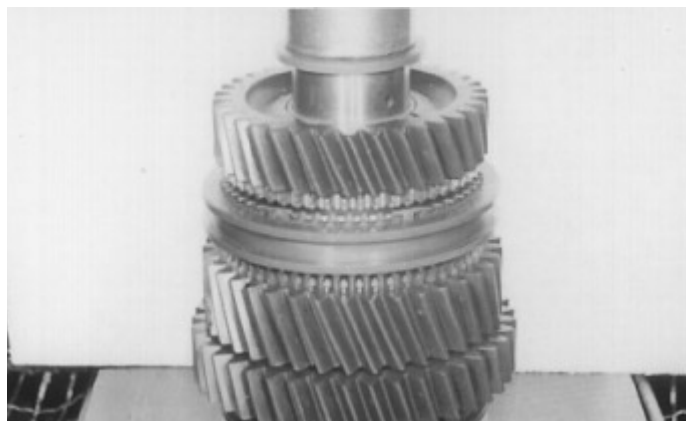
23. Tome a luva de rolamento de 2a marcha aquecida e posicione-a dentro do rolamento sobre o eixo. Utilize a prensa para assegurar que a luva esteja firmemente ajustada sobre o cubo sincronizador.
