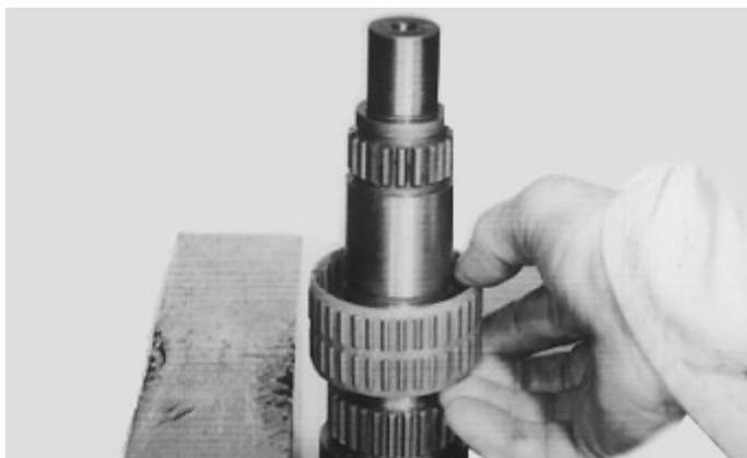
14. Remova o rolamento de agulha e seu respectivo espaçador da engrenagem de 1a .
