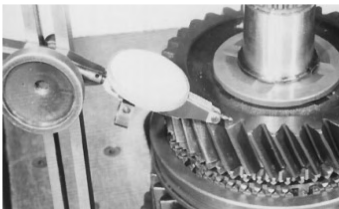
26. Certifique-se de que a folga axial esteja dentro da tolerância especificada na tabela.
