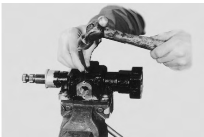
11. Inverta a carcaça. Alinhe o pino elástico na alavanca interna com orifício do plugue expansivo e puncione o pino. Remova o eixo e a alavanca interna.
