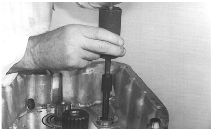
22. Rosqueie o martete deslizante MS 284 na parte traseira do eixo da engrenagem louca de ré e retire o eixo da carcaça. Remova o pino do eixo.
