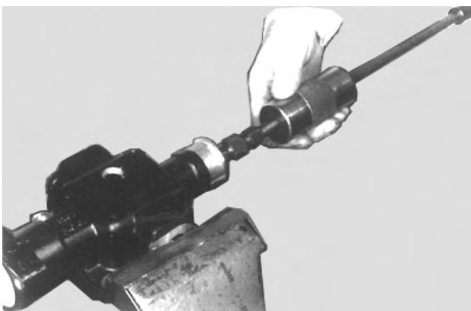
1-Caso necessário, substitua as buchas da carcaça. Utilize a ferramenta MS 284-1 para a remoção e a ferramenta E109-5 para instalar as novas buchas.
