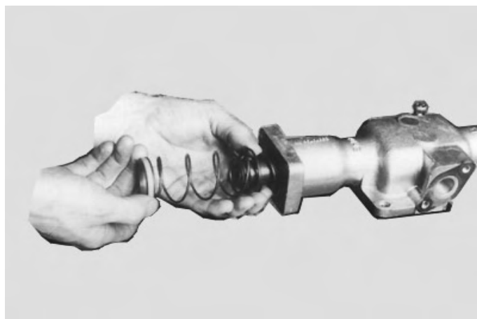
6. Remova o anel de retenção e o retentor da mola. Retire as molas.
