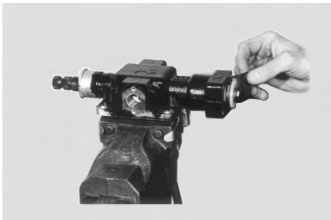
7. Instale o anel de encosto e posicione a tampa externa com uma nova junta de vedação, comprimindo a(s) mola(s) para dentro da carcaça.
