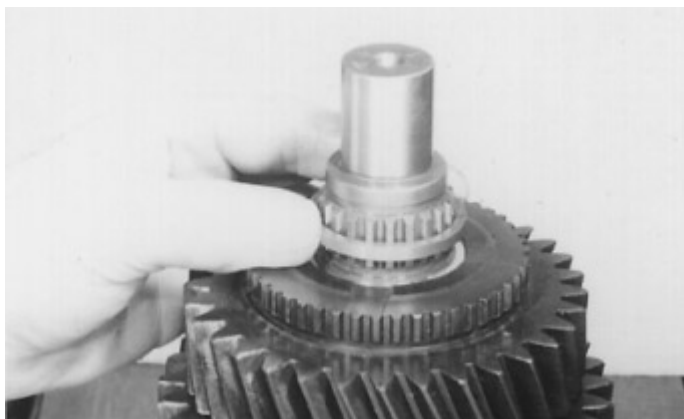
28. Coloque o espaçador do rolamento da engrenagem de 3a marcha na engrenagem sobre o rolamento.
