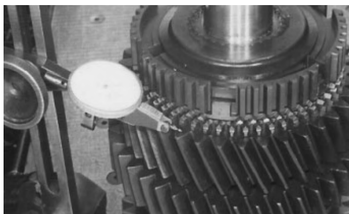
19. Verifique se a folga axial da engrenagem está dentro das especificações.
