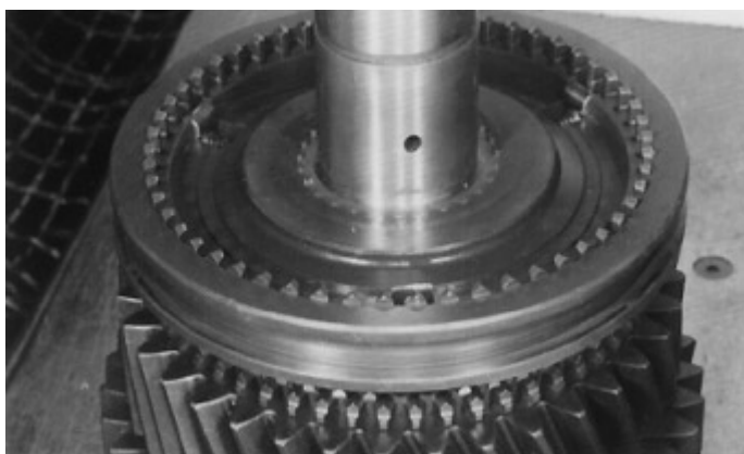
20. Monte as três molas e êmbolos no cubo e instale a luva sincronizadora de 1a /2a e os roletes com o descrito na subetapa 9.
