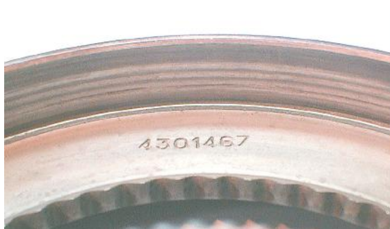
Figura 22 Marcas de aquecimento excessivo na capa
