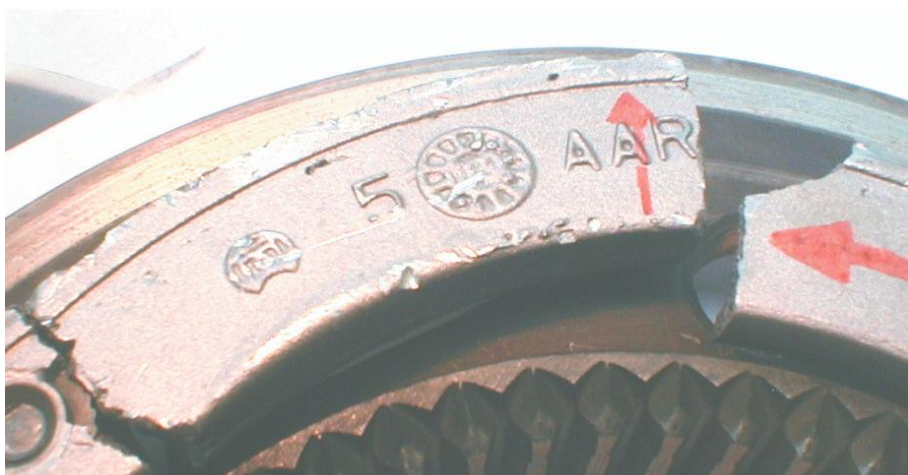
Figura 21 - Anel quebrado. A quebra do anel foi provocada por condições de esforços superiores às previstas no projeto do mesmo.
