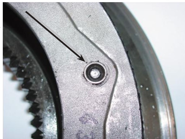
Figura 33 Má formação da cabeça do rebite
