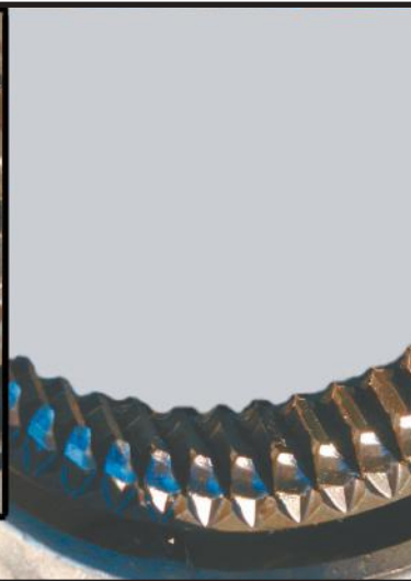
Figura 16 - Dentes de engate cisalhados
